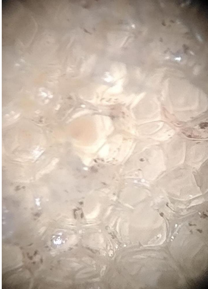
Figura. Esponja de poliuretano colonizado con A. niger observado con estereoscopio. En la imagen se pueden observar las esporas características de A. niger en color negro.
